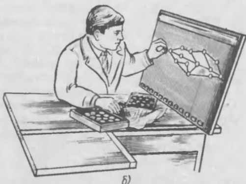
Рис. 1. Сетевое планирование ремонта: а — модель сетевого графика, б — универсальный кондуктор для составления сетевых графиков
