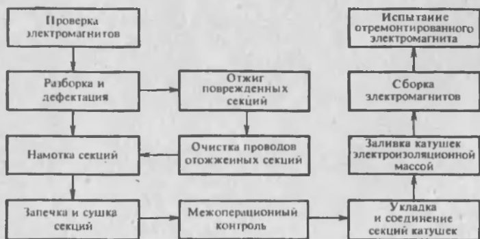
Рис. 27. Структурно-технологическая схема ремонта грузоподъемных электромагнитов
